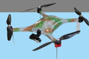
Беспилотный авиационный комплекс (БАК) «Шершень» на базе беспилотных летательных аппаратов мультироторного типа предназначен для ведения воздушной оптико-электронной разведки местности в любое время суток, выполнен в «носимом» исполнении.
